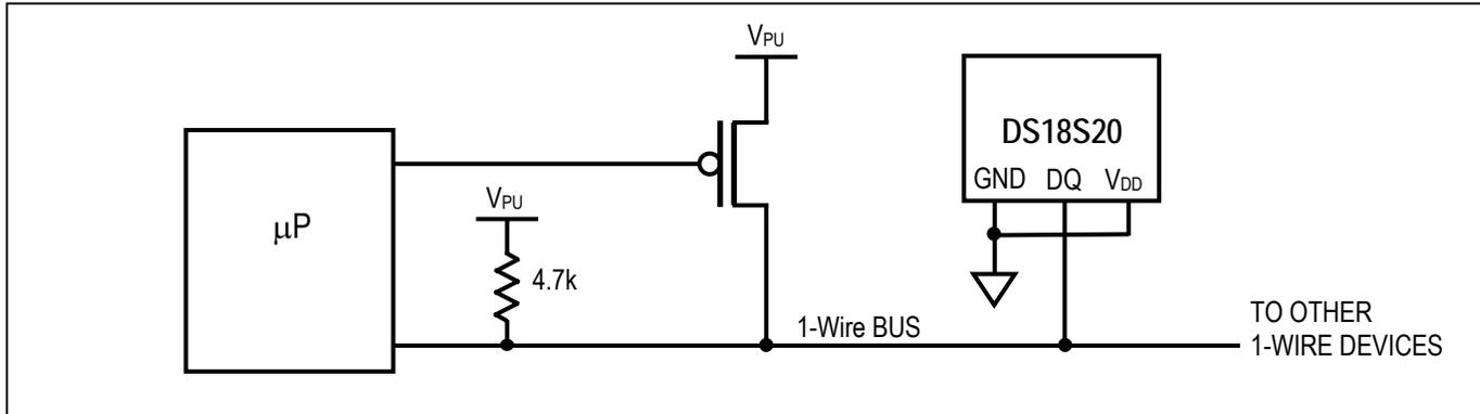
**Figure 5. Powering the DS18S20 with an External Supply**
